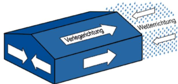
Bei horizontaler Verlegung erfolgt die Montage von unten nach oben.
